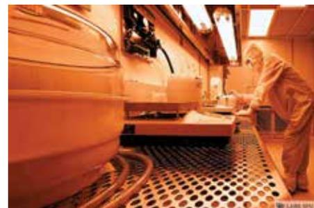
Dans une salle blanche du 4D LABS, à la Simon Fraser University, un chercheur traite PDMS (polydiméthylsilylène), un polymère utilisé dans les laboratoires sur puce, des minuscules circuits qui peuvent servir à la recherche médicale.
